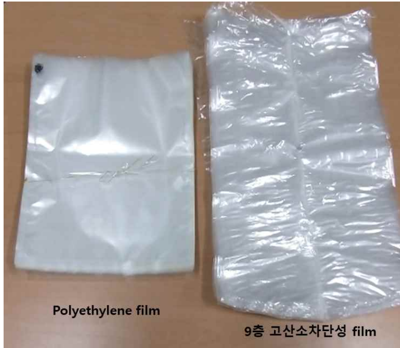
Fig. 3 한우 저장안정성 시험에 사용한 PE film, 9층 고산소차단성 필름
